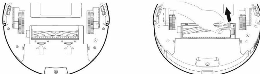
Aby usunąć główną środkową szczotkę czyszczącą, naciśnij obie wypustki na osłonie szczoteczki. Za pomocą narzędzia czyszczącego usuń włosy zaplątane w główną szczotkę. Centralną szczotkę czyszczącą należy chronić przed dużą ilością włosów, kurzu, bawełny itp.
