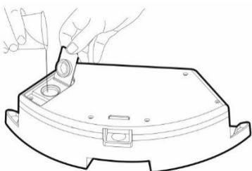
Odklopte plastovou krytku a naberte vodu do zásobníku na vodu. Vodu do nádobky pro vytírání vodou doplňujte výhradně po vyjmoutí nádobky z vysavače. Při manipulaci s nádobkou pro vytírání vodou může dojít k mírnému úniku např. zbytkové vody. V takovém případě polité místo ihned utřete suchým hadrem.
