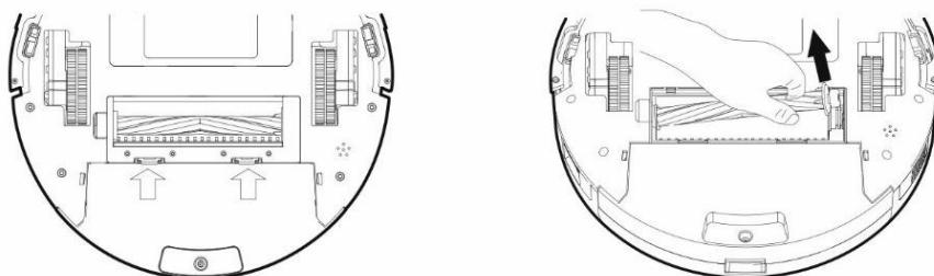
Odstranite glavno ščetko tako, da pritisnete oba jezička na pokrovu ščetke. Za odstranjevanje las, navitih v glavno ščetko uporabite čistilno orodje. Osrednja ščetka za čiščenje naj bo vedno čista: brez večje količine las, prahu, bombaža itd..
