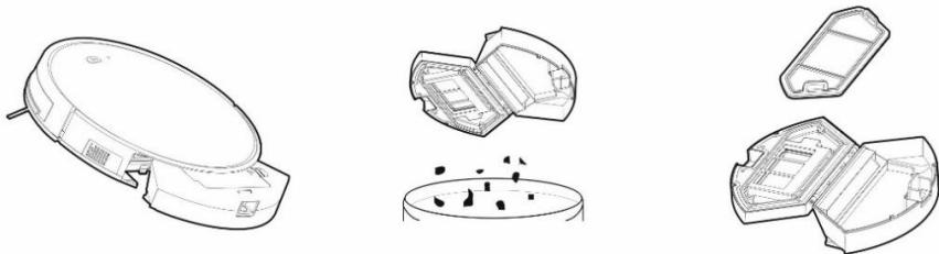
Stlačte uvoľňovacie tlačidlo pre vybratie zásobníka na nečistoty a vysypte nečistoty do odpadkového koša.
