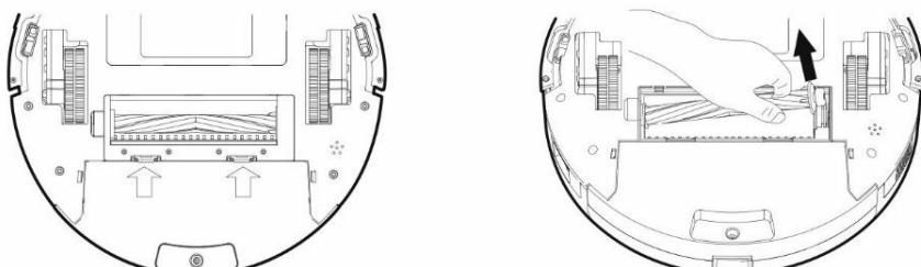
Hlavní středový čistící kartáč vyjměte stisknutím obou úchytek na krytu kartáče. K odstranění vlasů zamotaných do hlavního kartáče použijte čistící nástroj. Udržujte středový čistící kartáč bez většího množství vlasů, prachu, bavlny apod.
