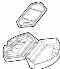
Naciśnij przycisk zwalniający, aby wyjąć pojemnik na kurz i opróżnij do pojemnika na śmieci.
