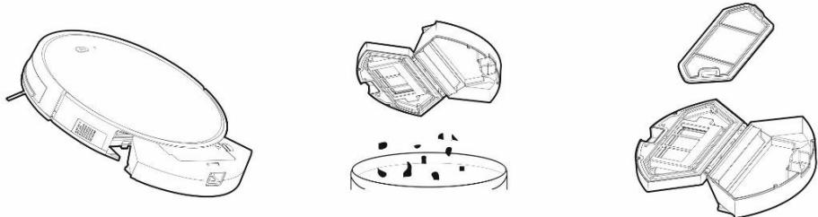
Nyomja meg a portartály kioldó gombot és a szemetet ürítse ki a kukába. Az elsődleges szűrőt ajánlott kéthetente tiszta vízben kimosni.
