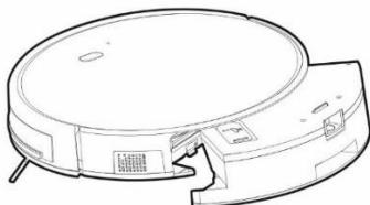
Introduceți cu atenție rezervorul de apă în corpul aspiratorului robot. Nu uidați aspiratorul sau partea sa interioară cu apă, aspiratorul robot nu este rezistent la apă. Conectați-l la stația de încărcare.
