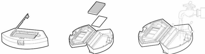
Vyčistěte HEPA filtr pravidelně dle míry jeho znečištění, minimálně jednou týdně, prachovým štětcem nebo vysaje klasickým vysavačem.
