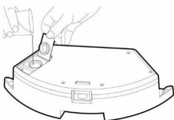
Otklopite plastični poklopac i ulijte vodu u spremnik za vodu. Dodajte vodu u spremnik za brisanje vodom samo nakon što ste spremnik izvadili iz usisavača. Pri rukovanju spremnikom za brisanje vodom može doći do laganog curenja, npr. ostatka vode. U tom slučaju poliveno mjesto odmah obrišite suhom krpom. Preporučamo brisanje poda čistom vodom jer se sredstvo za čišćenje može pjeniti i tako pogoršati kapanje vode na krpu za brisanje ili uzrokovati mrlje na podu nakon sušenja.
