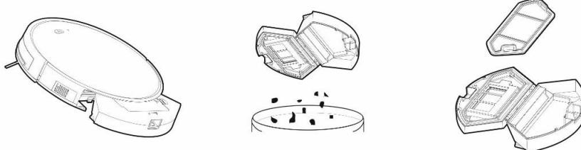
HEPA filter redno očistite glede na stopnjo njegove onesnaženosti, vsaj enkrat na teden, s krtačo za prah ali ga vakuumirajte s standardnim sesalnikom.
