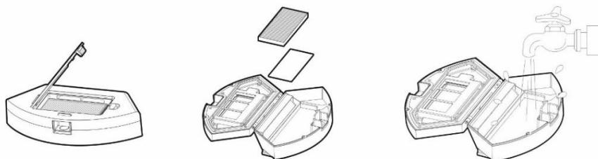
Vycistite HEPA filter pravidelne podľa miery jeho znečistenia, minimálne raz týždenne, prachovým štetcom alebo vysajte klasickým vysávačom. Nádobu na nečistoty môžete zbaviť prachu čistou vodou.
