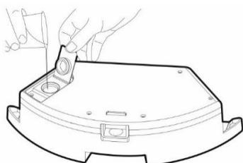
Deschideți capacul din plastic și turnați apă în rezervorul de apă. Turnați apă în rezervorul de apă numai după scoaterea rezervorului din aspirator. La manipularea cu rezervorul de apă, poate avea loc o ușoară scurgere de ex., de apă reziduală. În acest caz, ștergeți imediat zona udată cu o cârpă uscată. Vă recomandăm să spălați podeaua cu apă curată, agentul de curățare poate produce spumă și, astfel, înrăutățirea picurării apei pe mop, eventual poate lăsa pete pe podeaua uscată.
