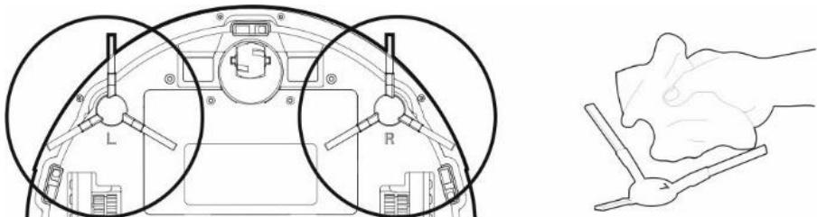
Co najmniej raz w tygodniu sprawdzać szczotki czyszczące z obu stron wraz z otworem wlotu powietrza pod kątem intensywności zabrudzenia oraz usuwać spletaną włosy i inne zabrudzenia.
