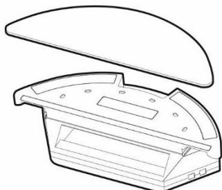
Zainstaluj niebieską ściereczkę do mopa na dnie zbiornika na wodę. Delikatnie zwilż szmatkę mopową wodą, aby szybciej i płynniej wycierać wodę. Podczas wyjmowania mopa z uchwytu uważaj, aby nie uszkodzić szybko zapięcia na rzep na uchwycie. Jeśli mop jest brudny po czyszczeniu, możesz go dokładnie umyć w letniej wodzie.
