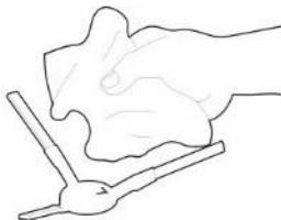
Zkontrolujte dle intenzity znečištění, minimálně jednou týdně, oba boční čistící kartáče společně s otvorem pro nasávání vzduchu a odstraňte z nich namotané vlasy a další nečistoty.
