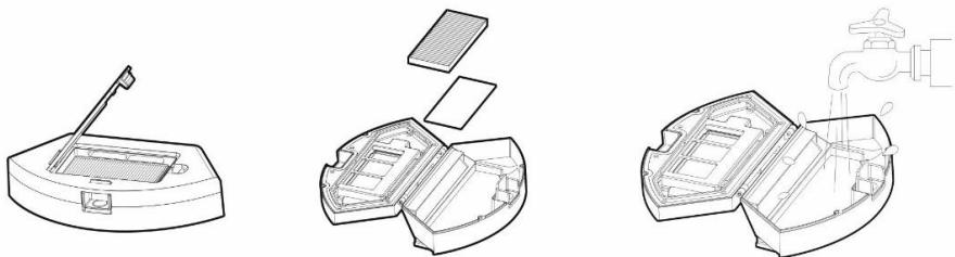
Curățați regulat filtrul HEPA în funcție de gradul de contaminare, cel puțin o dată pe săptămână, cu o perie de praf sau aspirați-l cu un aspirator standard.
