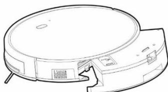
Previdno vstavite vsebnik za vodo v ohišje robotskega sesalnika. Aparat ni vodoodoren, zato sesalnika ali njegovih notranjih delov ne polivajte z vodo. Spravite ga v polnilno postajo.
