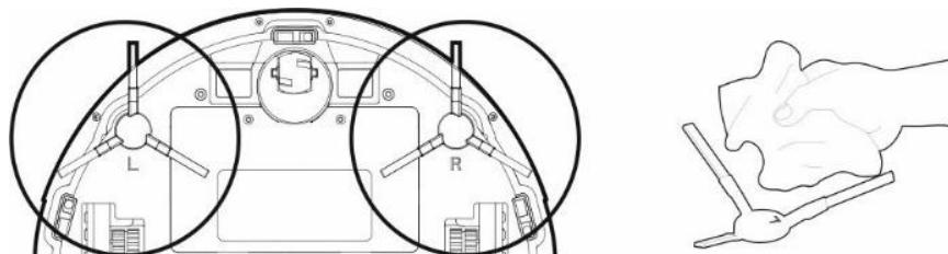
Skontrolujte podľa intenzity znečistenia, minimálne raz týždenne, oba bočné čistiace kefy spoločne s otvorm pre nasávanie vzduchu a odstráňte z nich namotané vlasy a ďalšie nečistoty.
