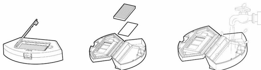
Filter HEPA čistite vsakih 14 dni s stresanjem s čopičem za prah ali posesajte s sesalnikom.
