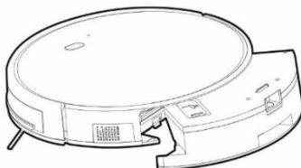
Oprezno umetnite spremnik za vodu u tijelo robotskog usisavača. Ne polijevajte robotski usisavač ni njegov unutarnji dio vodom jer nije vodootporan. Spojite ga na stanicu za punjenje.
