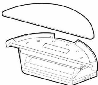
Instalați șesătura albastră de mop pe componenta inferioară a rezervorului cu apă. Umeziți ușor șesătura de mop cu apă pentru o spălare cât mai rapidă și continuă. La scoaterea mopului de pe suport, aveți grijă ca printr-o mișcare bruscă să nu deteriorați fermoarul tip velcro de pe suport.
