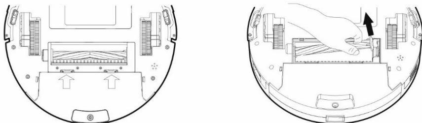
Hlavnú stredovú čistiacu kefu vyberte stlačením oboch úchytiek na kryte kefy. Na odstránenie vlasov zamotaných do hlavnéj kefy použite čistiaci nástroj. Udržujte stredovú čistiacu kefu bez väčšieho množstva vlasov, prachu, bavlny apod.
