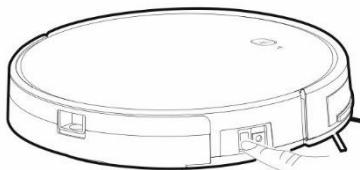
**Vklop:** stikalo za vklop premaknite v položaj **ON (1)**
